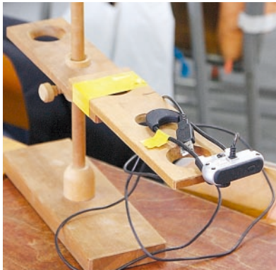
安価に入手できるUSB接続の通称WEBカメラを利用した、泉先生お手製の実物投写機。機材に欲を出せばきりがないが、知恵と工夫で授業をよりよくしたいという思いがにじむ。
